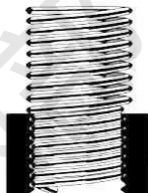
※ 钢丝螺套收缩旋入底孔示意图
